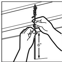
**Instale los alambres de suspensión.** Instale tornillos con rosca para madera a intervalos de 4' a lo largo de las líneas de cordel de las T principales. Fije un alambre de suspensión en cada tornillo y corte 6" debajo de la línea de la cuerda. Pliegue cada alambre de suspensión con un ángulo de 90 grados a 3/4" arriba de la línea de la cuerda.
