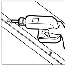
**Instale los ángulos de pared.** Alinee la parte superior de cada ángulo de pared con la línea de tiza. Separe los tornillos a cada 2' entre centros o menos.
