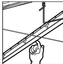
Tire de cada alambre de suspensión a través de un orificio circular debajo del bulbo de la T principal y dóblela hacia arriba, girando el extremo 3 vueltas (en un claro de 3").
