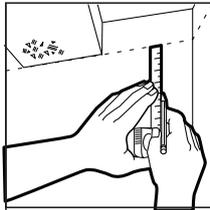
**Seleccione una altura de techo.** Deje una distancia libre mínima de 4" debajo del conducto de aire, tubería o viga más bajos. Trace una línea de tiza a 3/4" arriba de la altura de techo deseada.
